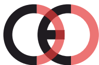
Faux marquage CE (trop proche)
